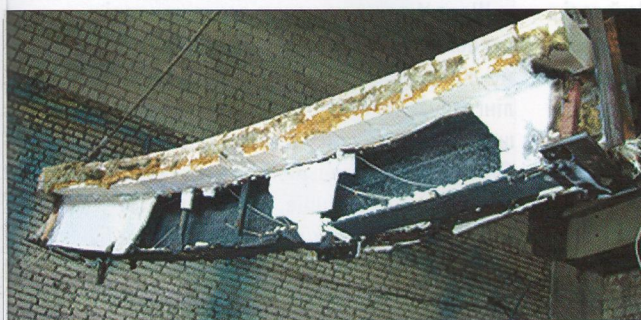
Рис. 3 – Зовнішній вигляд навантаженої балки з пасивним вогнезахисним матеріалом після проведення випробування
