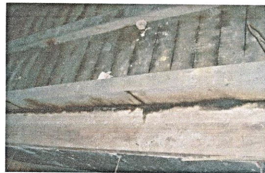
Рисунок 10. Вид образца после проведения огневых испытаний со стороны огневого воздействия и с противоположной стороны.
