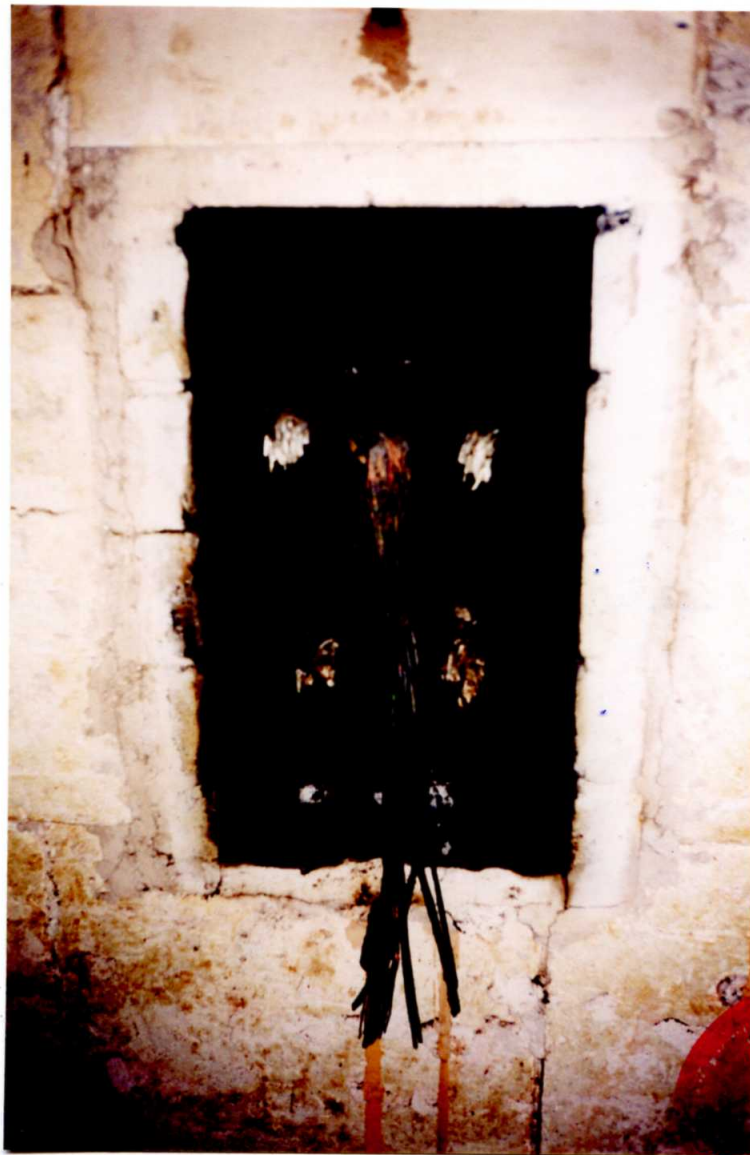
Рисунок 9. Внешний вид образца со стороны огневого воздействия после проведения испытаний
